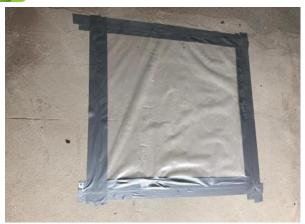
Перед нанесением грунта необходимо убедиться в том, что влажность бетона не превышает 5%. Для проверки влажности основания необходимо наклеить на поверхность полиэтилен размером 1 м на 1 м на сутки. На внутренней поверхности пленки не должно быть капель. Также для проверки влажности основания можно использовать влагомер (предназначенный для бетонных оснований).
